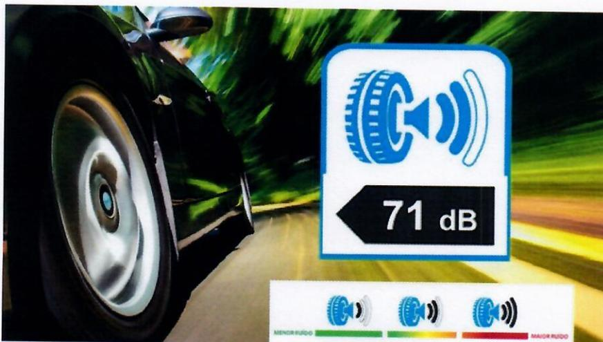
Esse som emitido externamente pelos pneus durante o deslocamento é medido em decibéis (db). A etiqueta mostra uma graduação na qual uma onda representa o pneu mais silencioso e três ondas apontam o pneu com níveis de ruído mais elevados e menos eficiente.
