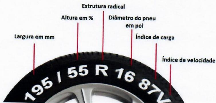
Afinal, o que significam os vários números e letras fixados na lateral de um pneu? Esses dados são as medidas e padrões que explicam detalhadamente o seu propósito e limites. Vamos usar o desenho acima como exemplo: 195/55R 16 87V
